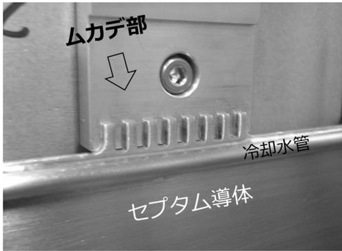
図 16: SMS1 のセプタム導体のおさえられる部分。
